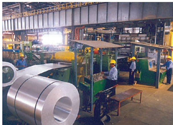
चित्र 6.3 – नाल्को प्रगलक में पट्टी लेप मिल
